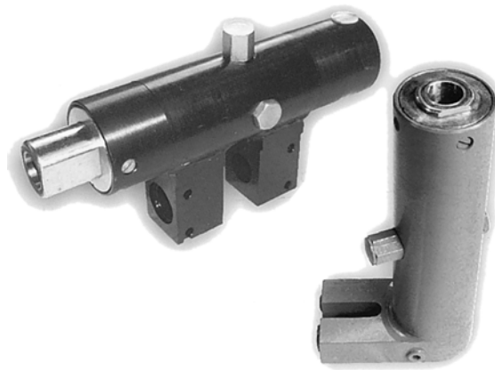
Рис. 3. Сварочные пистолеты для подачи и сжатия электродов вместе с рычагами во время сварки
