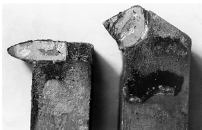
Рис. 4. Поверхность сая пластин сплава ВК-60М (слева на резбывом резце) и сплава ВК10-ХОМ (справа на расточном резце) и степень проплава в гнездах корпуса из отожженной стали 4Х5МФС при газопламенном нагреве для пайки смесью "АЛАРМет-ПС-47"
