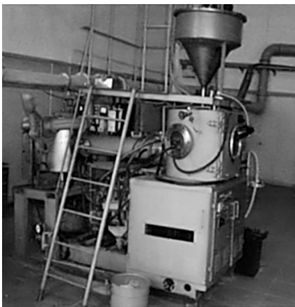
Рис. 2. Установка для перевода порошков из аморфного в нанокристаллическое состояние
