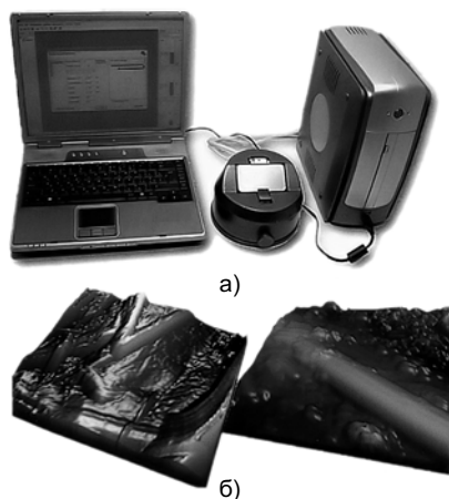
Рис. 5. Нанотехнологическое оборудование "УМКА" на базе сканирующего туннельного микроскопа (СТМ) (а) и нанотрубки, поле сканирования 2 \times 2 и 0,3 \times 0,3 мкм (б)
