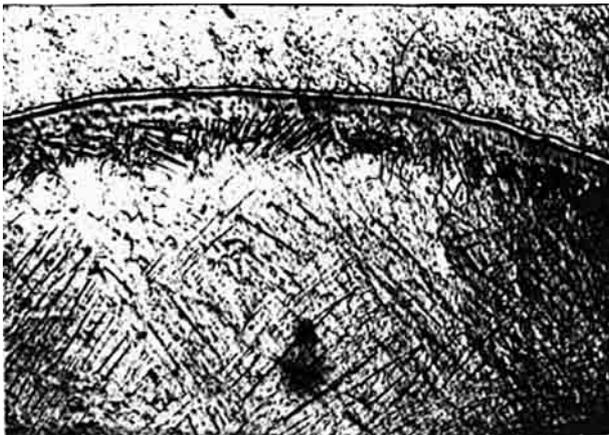
Рис. 5. Микроструктура ( $\times 300$ ) соединения титан — сталь, полученного диффузионной сваркой
