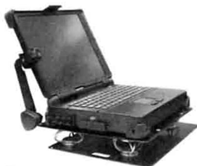
Рис. 2. Промышленный защищенный ноутбук *TS Strong Master 7020T (EC 1866)* серии Pentium
