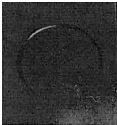
Рис. 3. Рентгенограмма паяного шва с неравномерной шириной зазора
