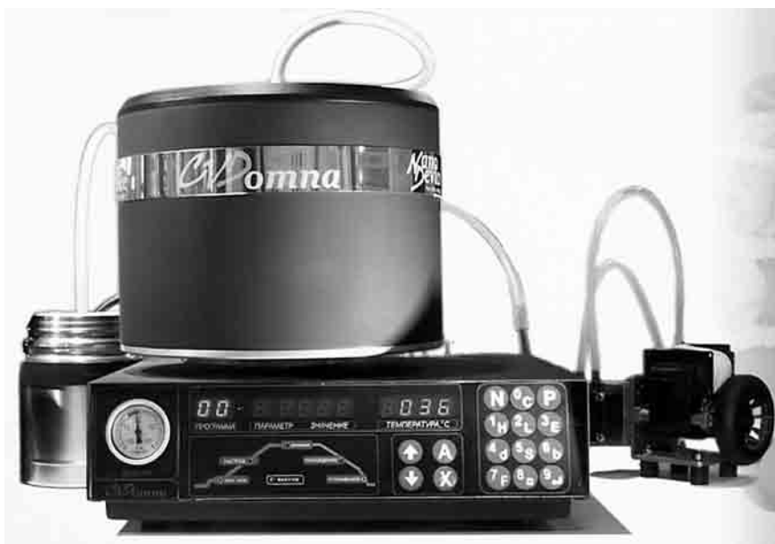
Рис. 7. Учебно-исследовательская установка роста углеродных нанотрубок CVDomna
