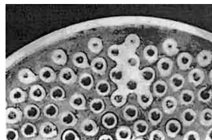
Рис. 2. Скопление припоя между форсунками
