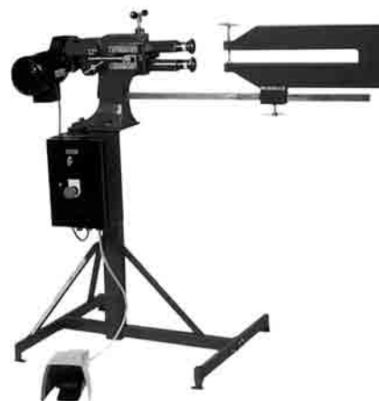
Рис. 6. Зиговочная машина S250/50M
