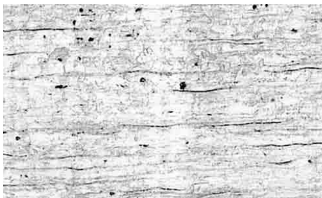
Рис. 1. Микроструктура стали 12Х18Н10Т. × 200
