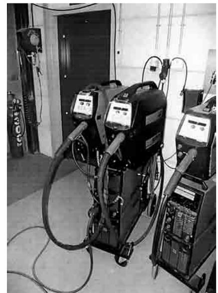
Рис. 11. Сварочный аппарат FastMIG Synergic в комплектации с двумя подающими устройствами
