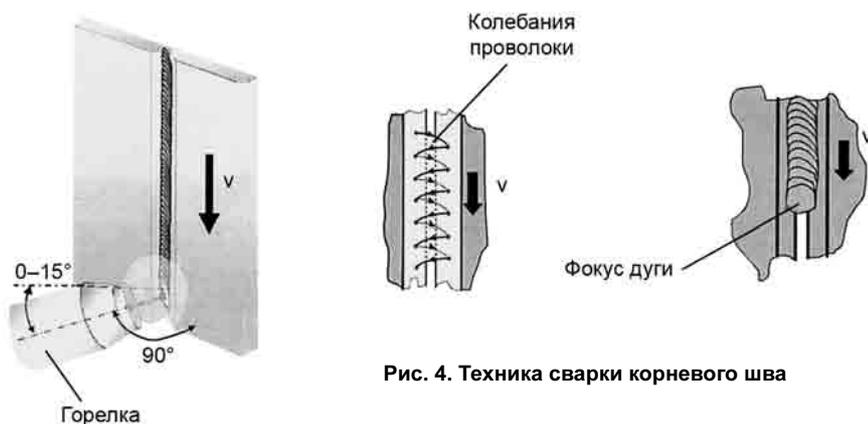
Рис. 4. Техника сварки корневого шва
