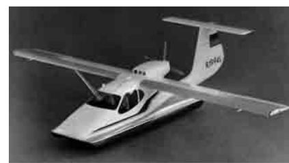
**Рис. 6. Безаэродромный четырехместный самолет с шасси на воздушной подушке**
