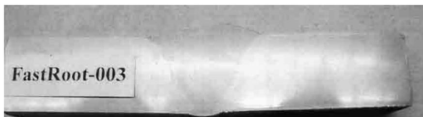
Рис. 5. Стыковой шов, V-образная разделка (60°), корневого прохода сварен с применением технологии FastROOT™ в вертикальном положении, заполнение — синергетической MIG-сваркой в вертикальном положении (зазор 3—4 мм, сварочный ток 130 А, напряжение 16 В, скорость сварки 138 мм/мин, энергия дуги  $E = 0,9$  кДж/мм, тепловложение  $Q = 0,72$  кДж/мм)
