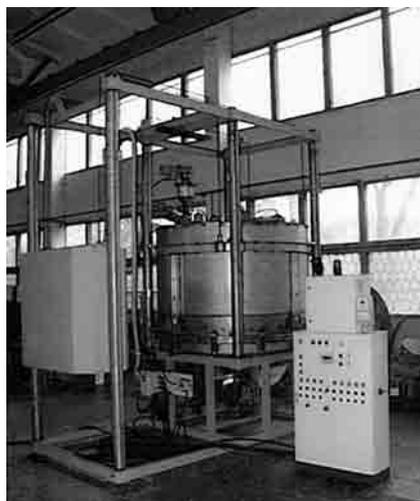
Рис. 2. Реактор полунепрерывного действия синтеза УНМ "Таунит"
