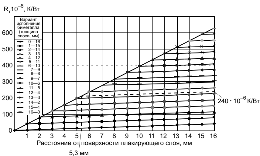
Рис. 3. Номограмма теплового сопротивления биметалла сталь 12Х18Н9Т—медь
