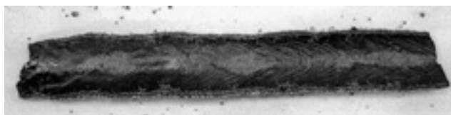
Рис. 1. Шлаковая корка при наплавке деталей вагонов под флюсом ФКН-7
