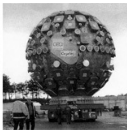
Рис. 6. Сварная сферическая камера "Laser Megajoule" (диаметр 11,0 м, масса ~100 т) для комплекса термоядерных исследований: а — сварка и контроль в цехе; б — готовая камера подготовлена к транспортировке
