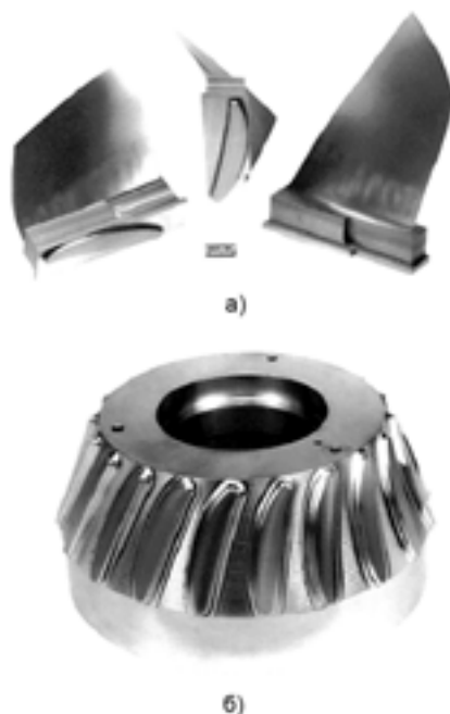
Рис. 8. Лопатки (а), полученные точной штамповкой, и диск с выступами (б) для соединения с лопатками
