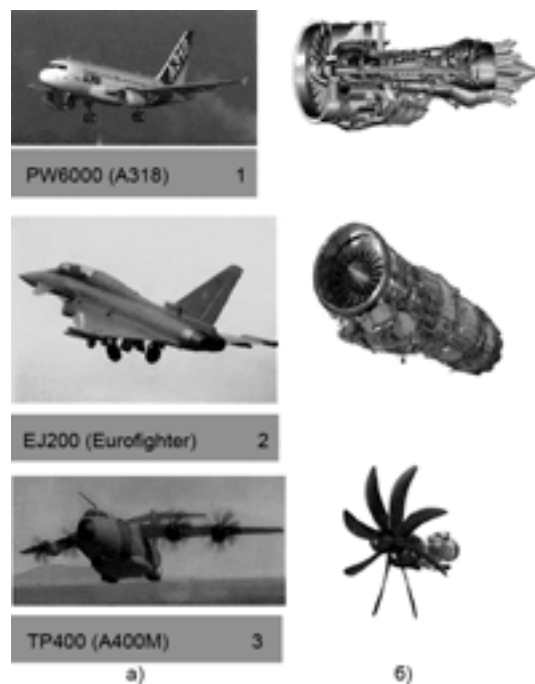
Рис. 12. Самолеты (а) и их авиадвигатели (б), в которых используются блиски, поставляемые MTU Group: 1 — Airbus; 2 — европейский истребитель; 3 — турбовинтовой самолет
