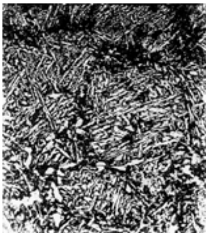
Рис. 7. Участок основного металла у ЗС после наплавки с обогащенными границами первичных аустенитных зерен
