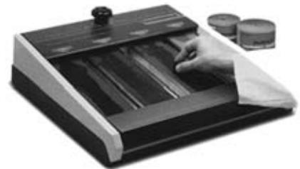
Рис. 7. Настольный ручной шлифовальный станок ленточного типа Handi Metl
