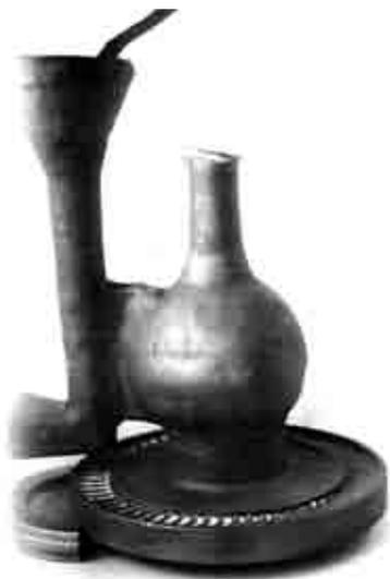
Рис. 5. Отливка детали типа диск
