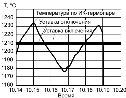
Рис. 3. Результаты измерения температуры солевой печи
