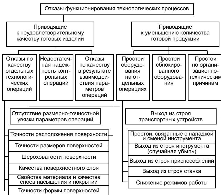
Рис. 1. Структурно-логическая схема отказов функционирования технологических процессов
