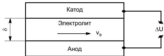
Рис. 1. Схема электрохимической ячейки
