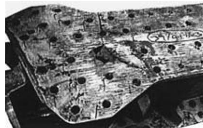
Рис. 7. Трещины и изломы, возникающие в несущих конструкциях при жестких посадках
