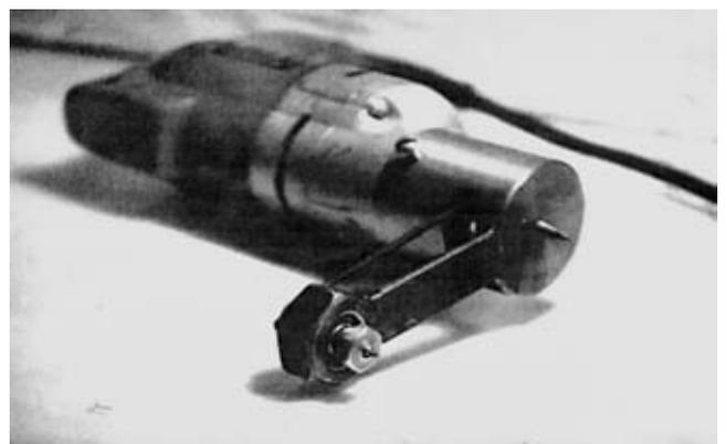
Рис. 6. Инструмент для сверления зондирующих отверстий
