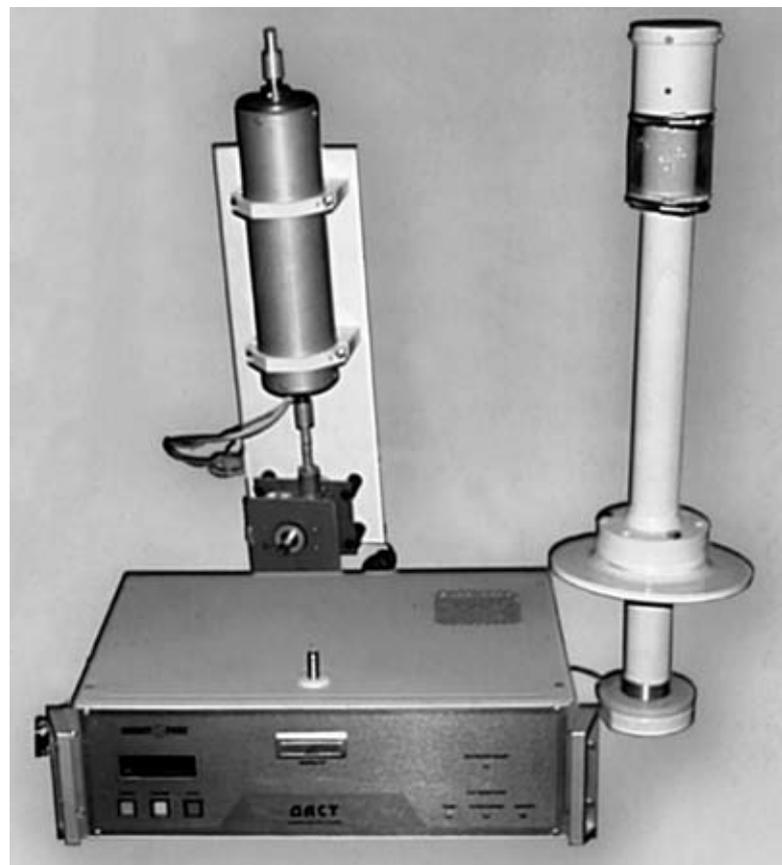
Рис. 5. Стационарный анализатор пыли ДАСТ
