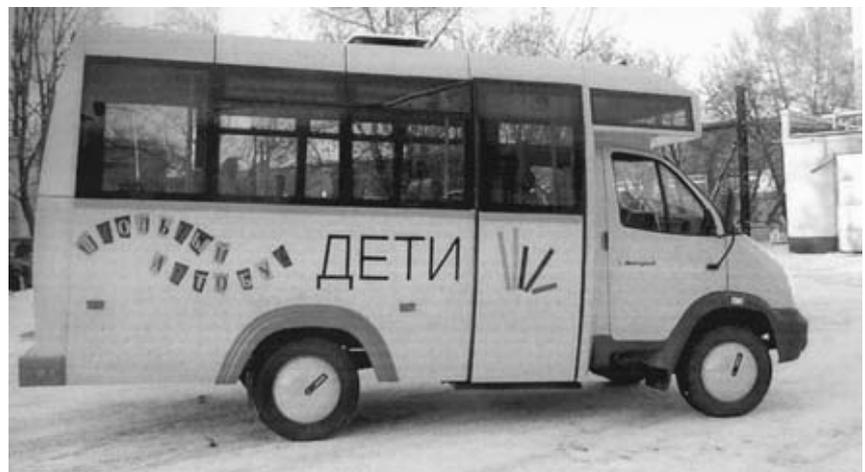
Рис. 2. Экспериментальный 13-местный школьный автобус на шасси автомобиля "Валдай"
