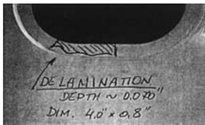
Рис. 5. Расслоение с внешней стороны иллюминатора
