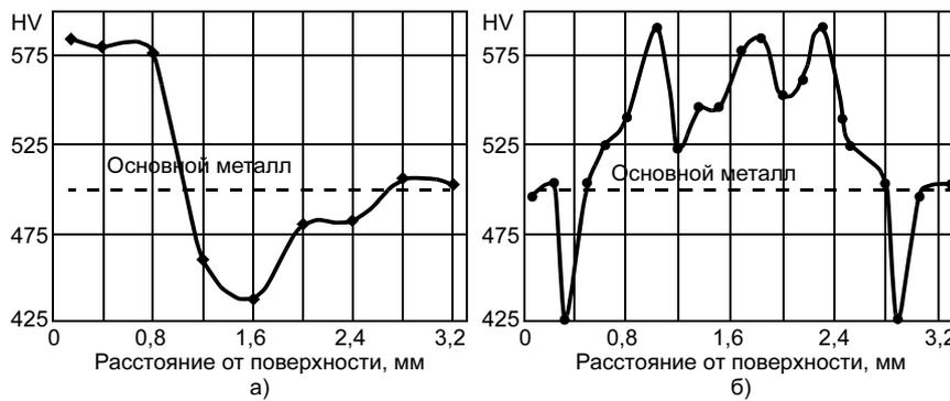
Рис. 8. Распределение твердости по глубине (а) и ширине закаленной дорожки на глубине 0,3 мм (б) при плазменной закалке стали 5ХНМ
