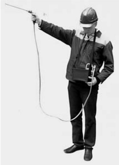
Рис. 4. Малогабаритный газоанализатор "Монолит"
