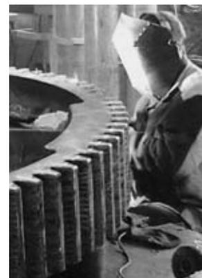
Рис. 5. Ручная плазменная закалка зубчатого венца сталеразливочного крана грузоподъемностью 225 т
