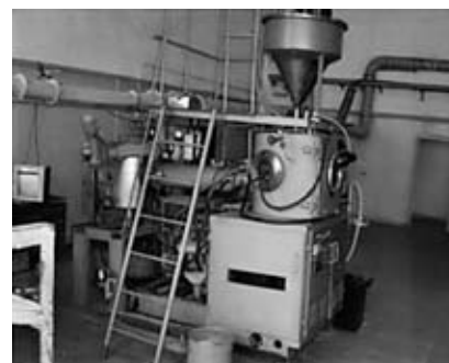
Рис. 2. Установка для перевода порошков из аморфного в нанокристаллическое состояние
