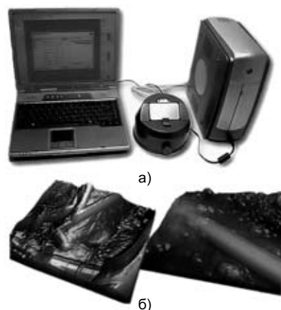
Рис. 5. Нанотехнологическое оборудование "УМКА" на базе сканирующего туннельного микроскопа (СТМ) (а) и нанотрубки после сканирования 2 × 2 и 0,3 × 0,3 мкм (б)
