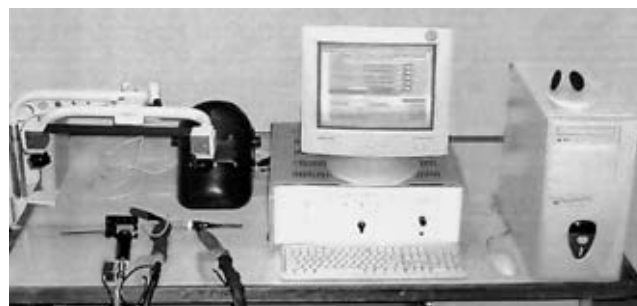
Рис. 1. Малоамперный дуговой тренажер сварщика МДТС
