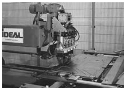
Рис. 5. Координатный промышленный робот точечной и рельефной сварки в кондукторах CSR 302
