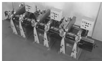
Рис. 2. Технологическая линия — станки 128D для шлифования длинномерных труб
