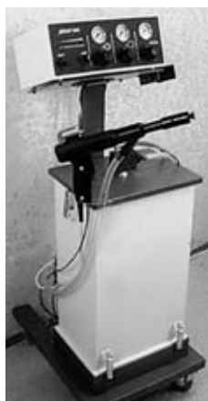
Рис. 3. Установка для электростатического напыления "Декор 2001"
