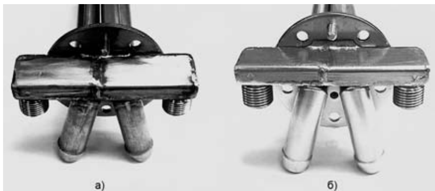
Рис. 8. Общий вид деталей до (а) и после (б) электролитно-плазменной обработки (ЭПО)
