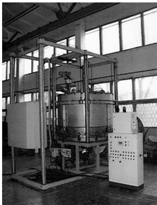
Рис. 2. Реактор полунепрерывного действия синтеза УНМ "Таунит"
