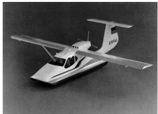
Рис. 6. Безаэродромный четырехместный самолет с шасси на воздушной подушке
