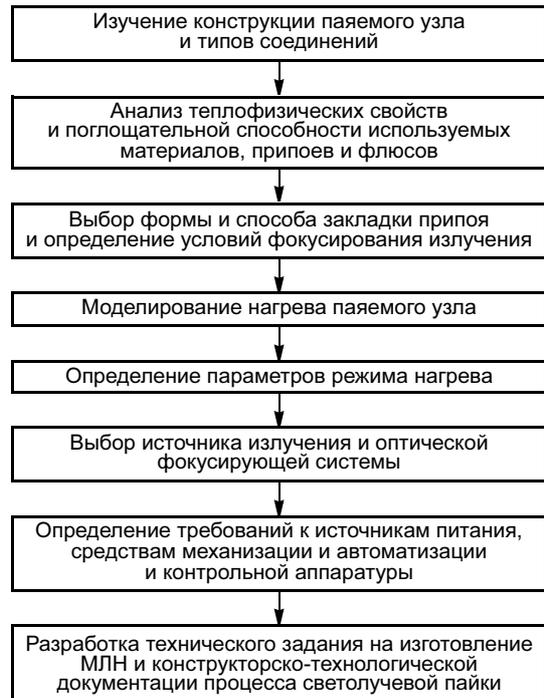
Рис. 5. Блок-схема этапов разработки технологии светолучевой пайки
