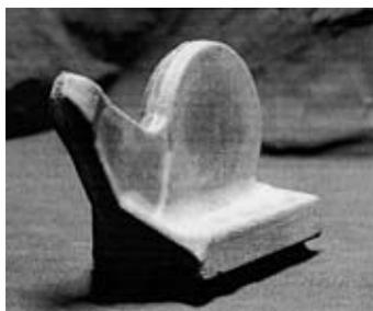
Рис. 1. Поковка Т-образного кронштейна
