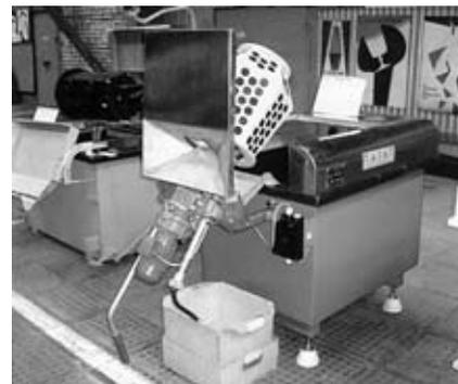
Рис. 5. Колокольная ванна серии ВК для нанесения электрохимических покрытий на мелкие детали
