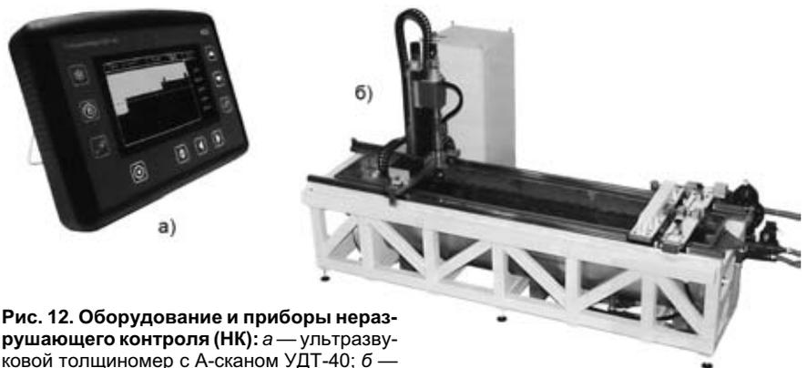
Рис. 12. Оборудование и приборы неразрушающего контроля (НК): а — ультразвуковой толщиномер с А-сканом УДТ-40; б — автоматизированная система НК валов авиационных двигателей АСНК-ВАЛ.АВИА
