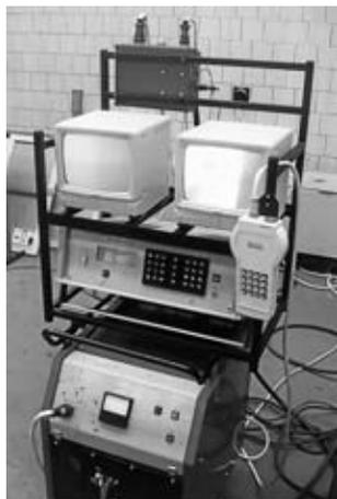
**Оборудование для орбитальной аргодуговой сварки, выпускаемое филиалом ФГУП "Росатомстрой" — НИКИМТ:** а—в — головка автомата ОДА-26М, ОДА-42-76П и СА-673 соответственно; г — аппаратура автомата СА-673 (источник, блок управления, ручной пульт, мониторы телевизионной системы)
