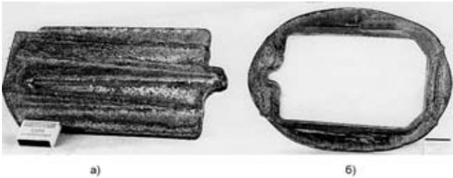
Рис. 6. Ш-образная поковка (а) после обрезки облоя (б)
