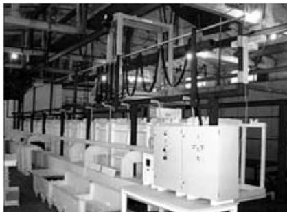
**Рис. 2. Гальваническая линия барабанно-подвесочного типа для покрyтий любых видов**
