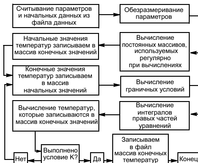
Рис. 2. Блок-схема "Расчет температурных полей в цилиндре при действии поверхностных тепловых источников" (условие K — выполнено хотя бы одно из условий: нажата клавиша Esc; источник теплоты достиг конца заготовки; температура превысила допустимую; выполнено заданное заранее число итераций)
