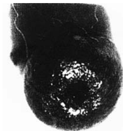
Рис. 2. Внешний вид капли электродного металла, сформировавшейся на торце проволоки ( \times 15 )
